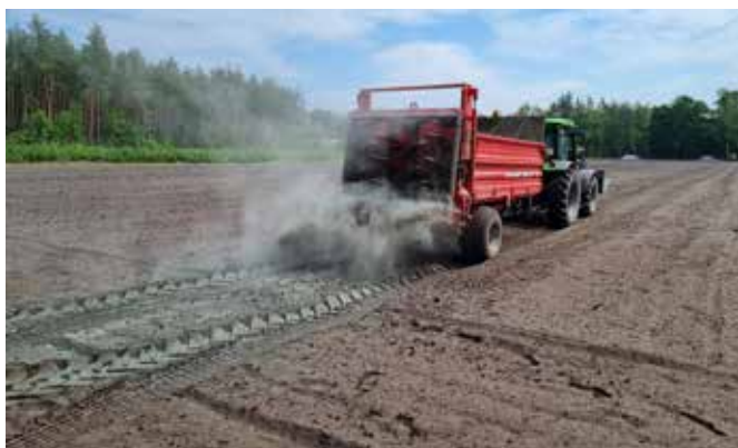
Obr. 4: Aplikace horninové moučky Brozit (dávka 30 t/ha) pomocí rozmetadla Pöttinger Twist 7001 na produkční ploše č. 400 v areálu Školkařského střediska Kladruby nad Labem (školkařský podnik LESOŠKOLKY s. r. o. Řečany nad Labem; www.lesoskolky.cz ; GPS souřadnice: 50°04'05,9''N, 15°28'54,6''E). Foto © Přemysl Němec (11. června 2021)
