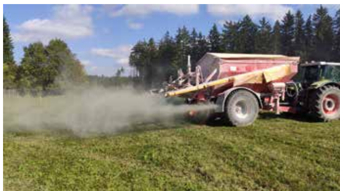
Obr. 1a, 1b: Rozmetání bazické silikátové moučky Brozit na pozemcích v katastrálním území obce Bohdalec (souřadnice GSP: 49°29'07,09"N, 16°03'20,16"E) pomocí kotoučového rozmetadla Bredal, řady K (typ K105L Auger). Foto © David Šimek [5. října 2021]
