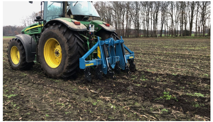
Obr. 1: Hlubokou přípravu půdy prováděná pomocí podrývaců Imants Culter – zde samostatně (lze i v agregaci s rýčovým strojem).
