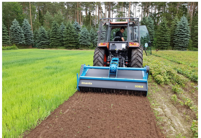
Obr. 2: Rýčový stroj Imants zajišťující jedním pojezdem střední až hlubokou přípravu půdy včetně optimálního způsobu zapravení zeleného hnojení.
