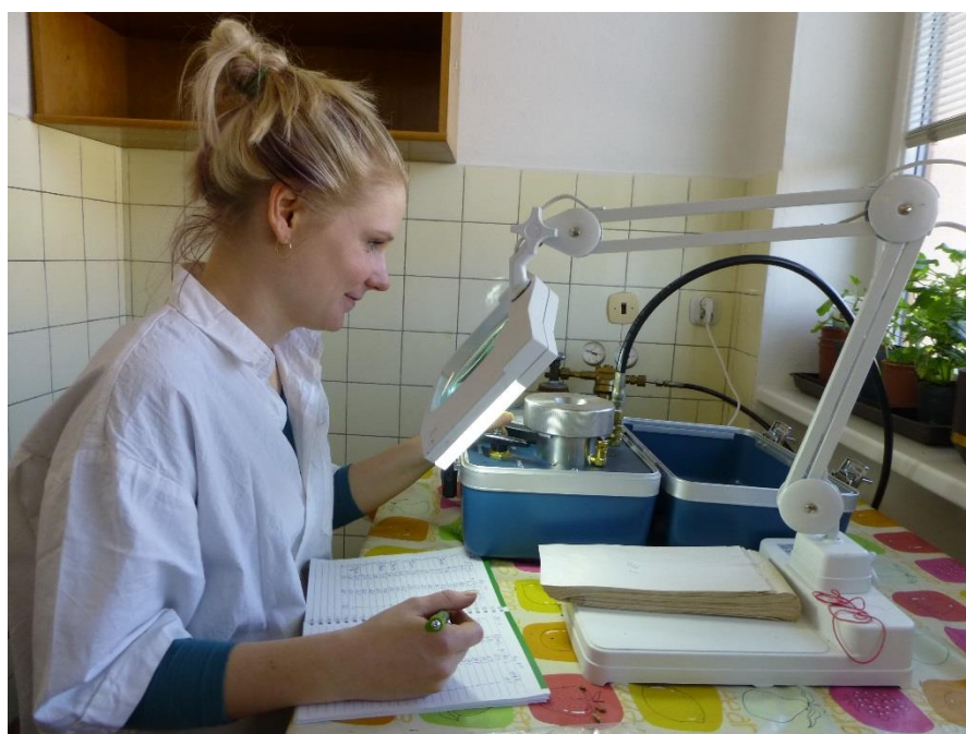
Obr. 7.2: Použití tlakové komory Model 1000
